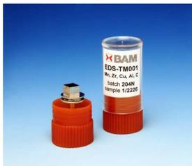
EDS-TM001 Testmaterial für Röntgenspektrometer
